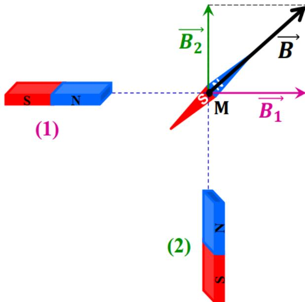
$\vec{B}_1$  C'est le champ magnétique créé par l'aimant 1 au point M
